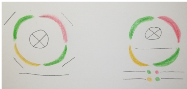
Obr. 6.2: Schéma znázorňujúca na ľavej strane aktuálnu podobu kruhových indikátorov a na pravej strane je zobrazený môj návrh na zobrazenie kruhového indikátora.
