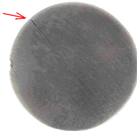
Obr. 1.4 Podélná trhlina v hutním polotovaru
