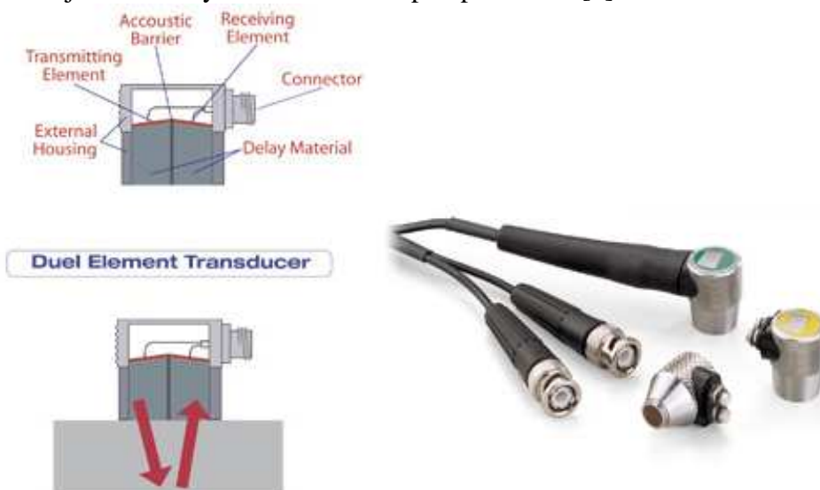
Obr. 2.12 Dvojitá sonda [10, 11]
