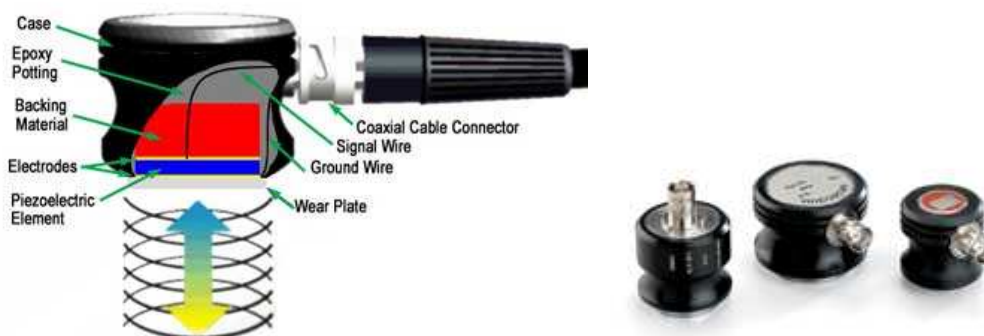
Obr. 2.10 Přímá sonda [6, 7]
