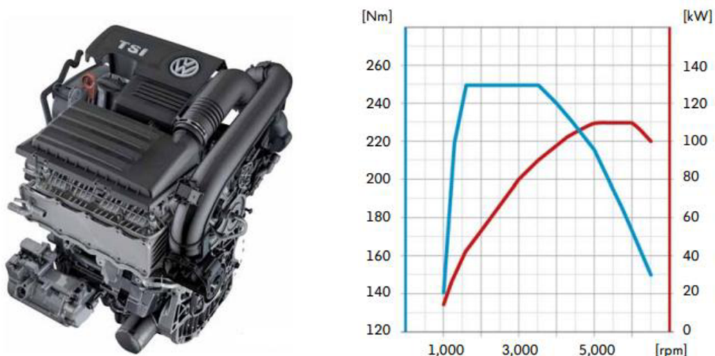
Obr. 12 Pohled na motor 1,4 TSI z řady EA211 a jeho charakteristika [13]
