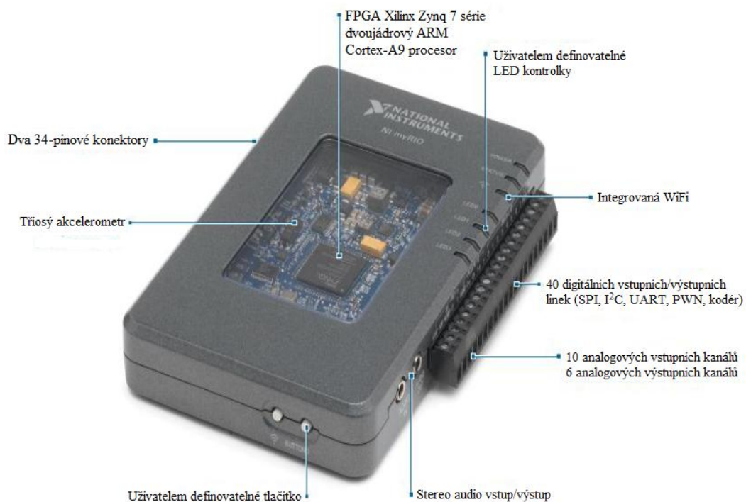
Obr. 6: NI myRIO-1900. Převzato a upraveno z [5].
