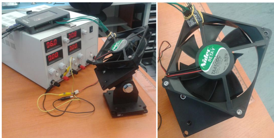
Obr. 20: Měřicí sestava – napěťový zdroj, NI myRIO, PmodACL a ventilátor.
