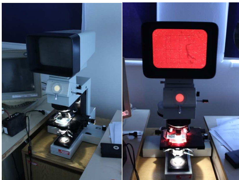
Obr. č. 11 a 12 - Mikroskop v laboratoři bez vzorku, se vzorkem ( s patrnými otvory po částicích alfa na monitoru) [Zdroj: A. Havlová]
