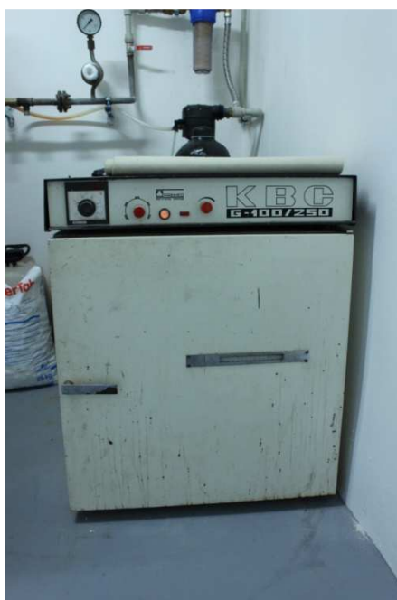
Obr. č. 13 - Sušárna na stopové detektory [Zdroj: A. Havlová]
