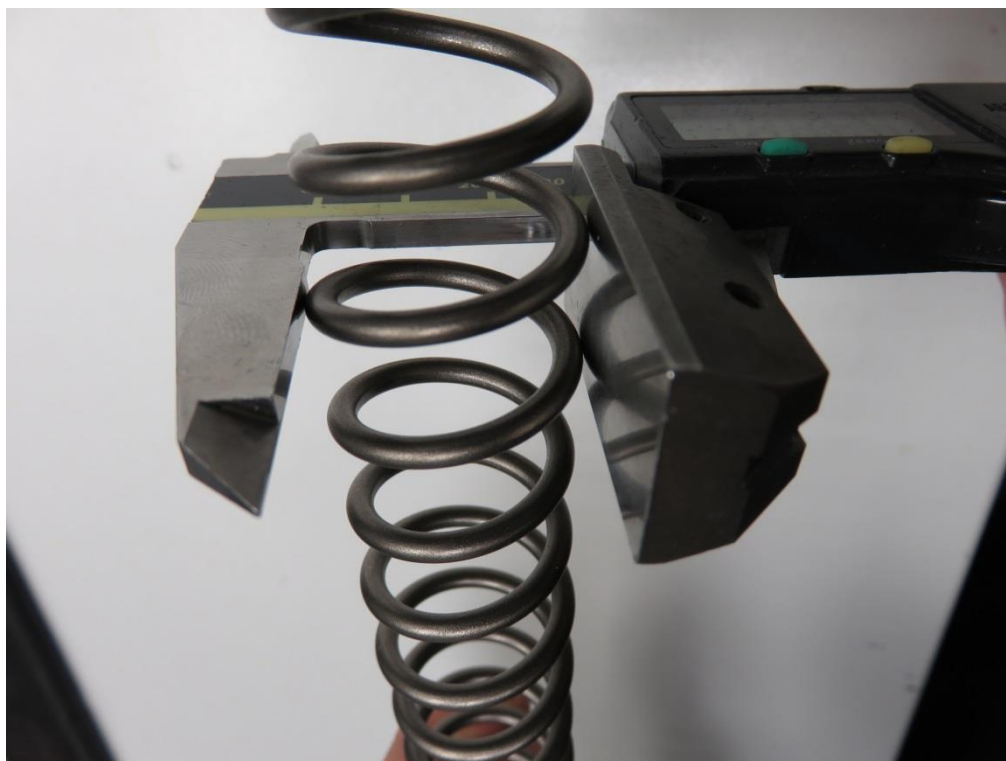
Obrázek VII. – Způsob měření vnějšího závitu tlačné pružiny
