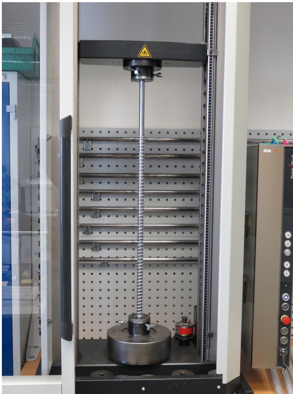
Obrázek XII. – Stroj pro měření síly pružin od firmy Zwick
