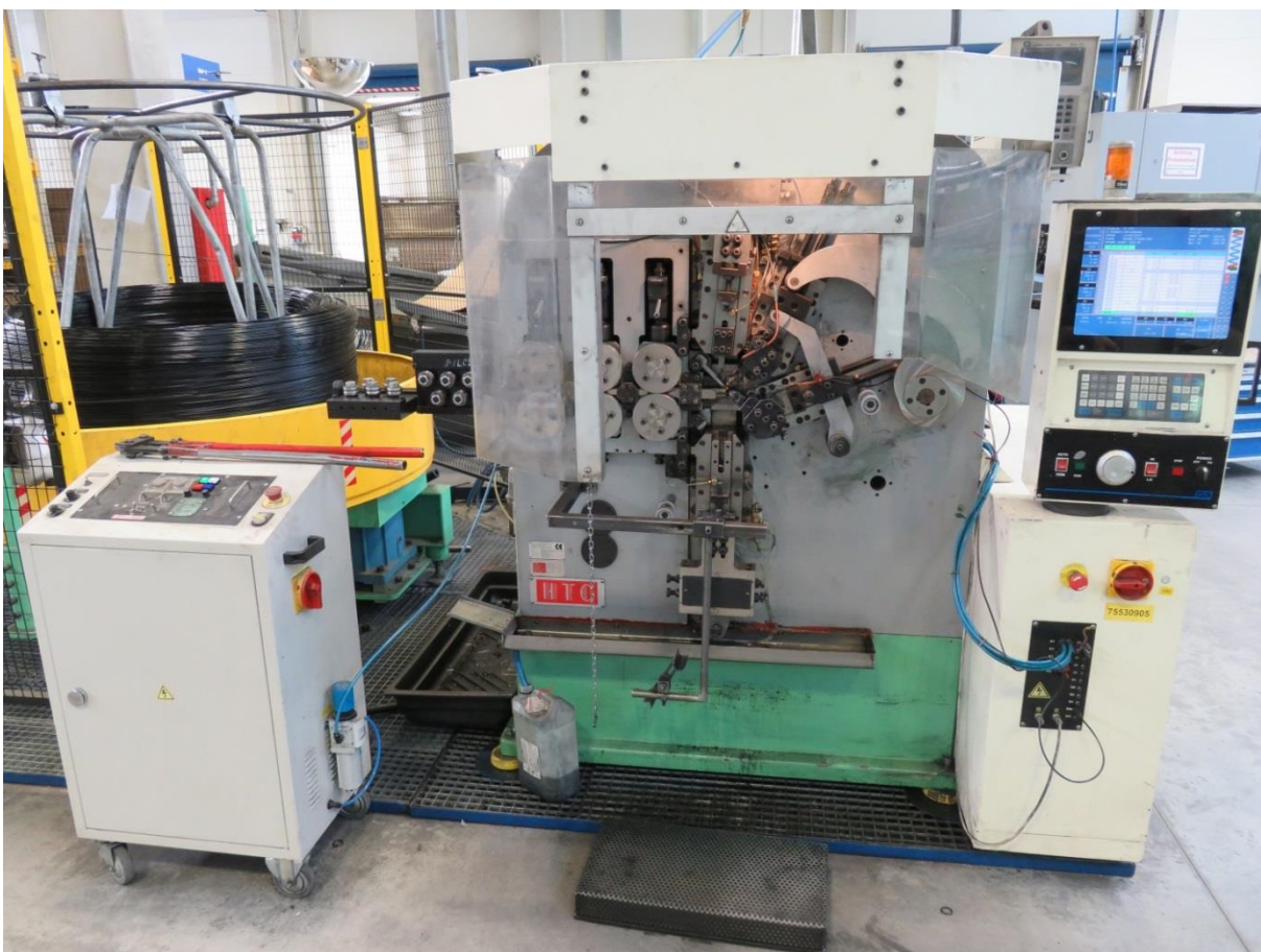
Obrázek VI. – navíjecí stroj HTC 60
