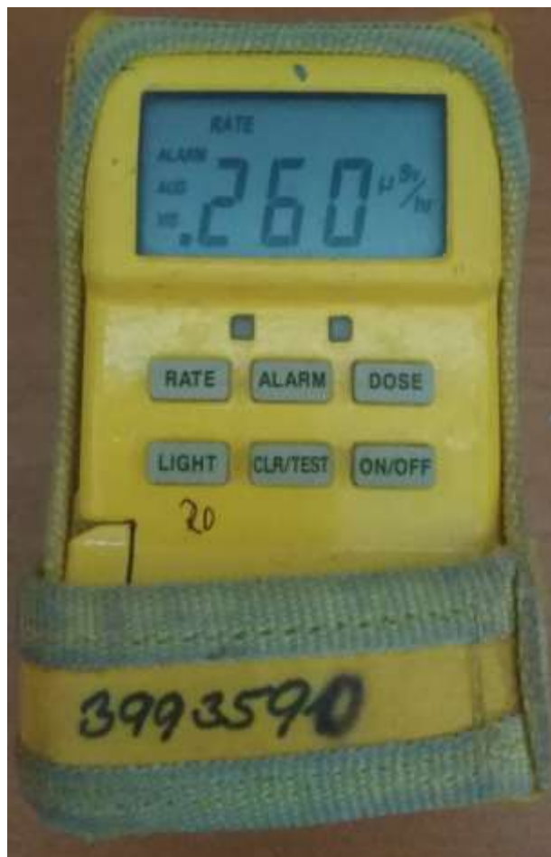
Obr. 7 Zásahový dozimetr URAD 115
