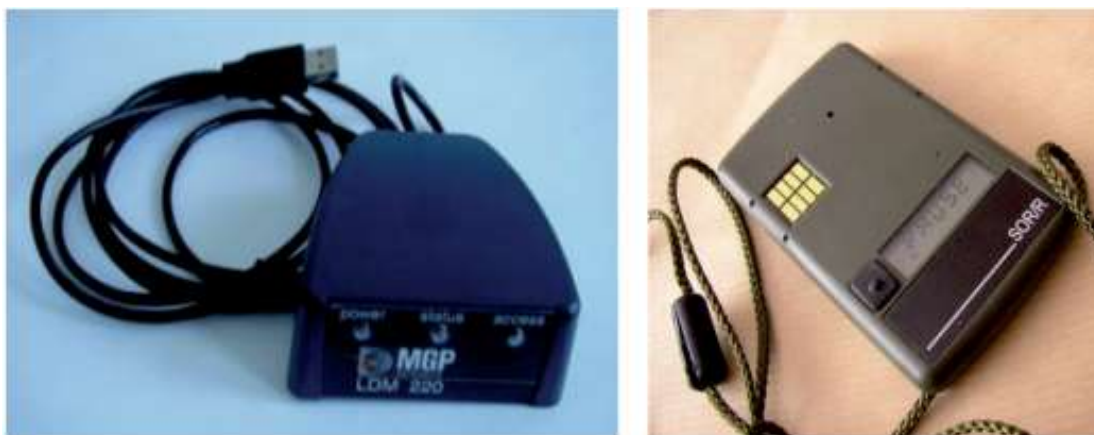
Obr. 6 Osobní dozimetr SOR/R022 se čtečkou
