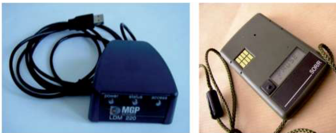
Obr. 6 Osobní dozimetr SOR/R022 se čtečkou
