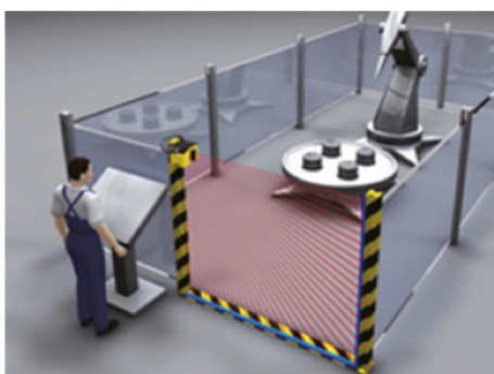
Obr. 2.1: Příklad izolace robota oplocením a optickými závorami[1]
