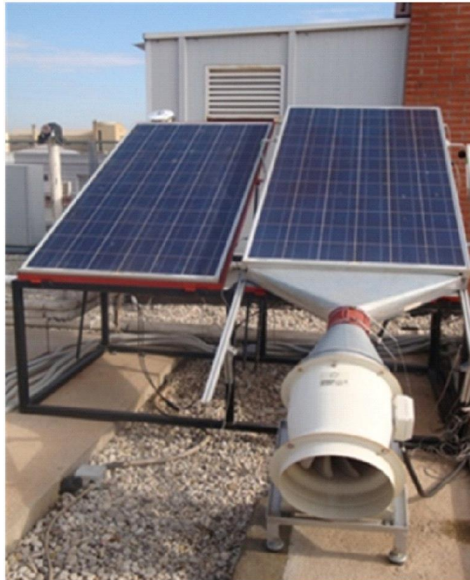
Obr. 6: Chlazení vzduchem přirozenou a nucenou konvekcí
