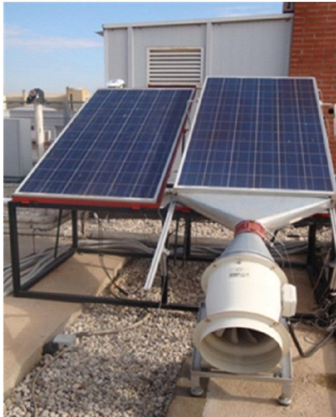
Obr. 6: Chlazení vzduchem přirozenou a nucenou konvekci
