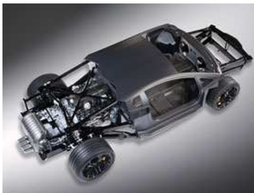
Obr. 7 Lamborghini a jeho stavba z monokoku
