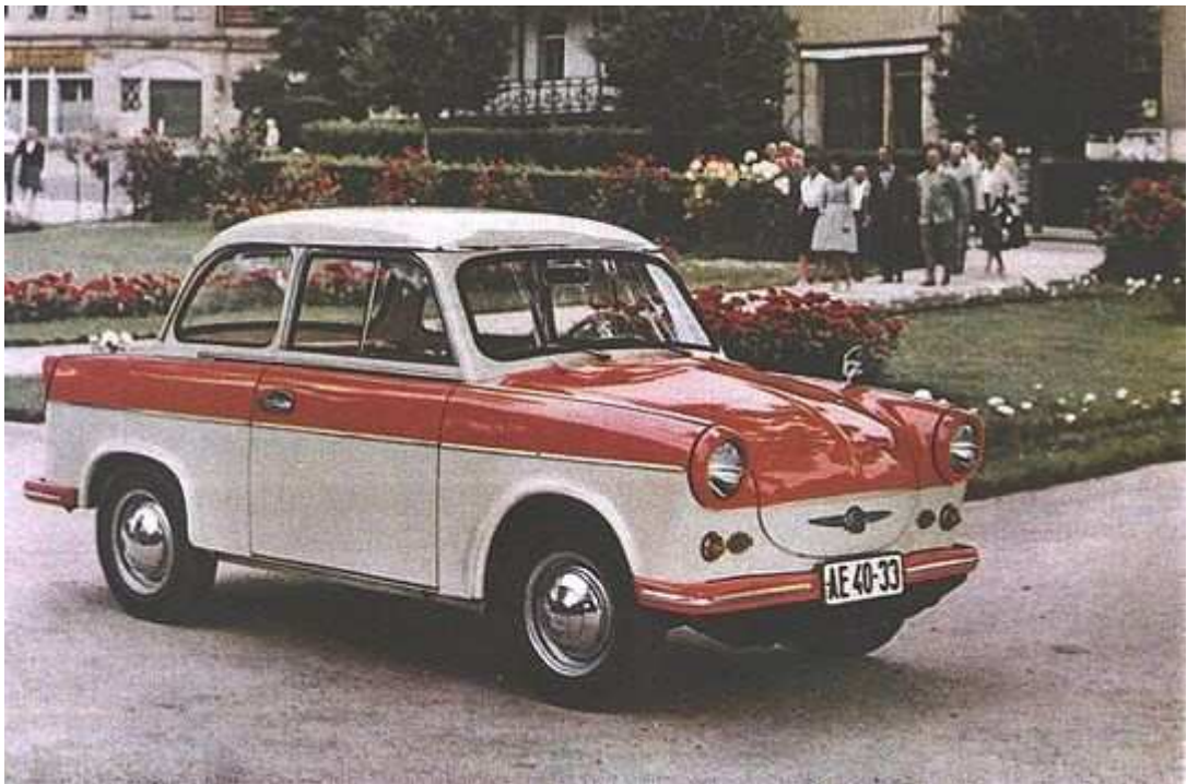
Obr. 5: Karoserie z duroplasty v trabantu
