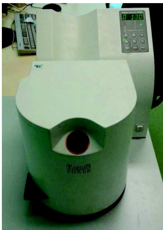
Obr. 10 Snímek vytvrzovacího zařízení
