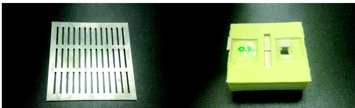
Obr. 11 Snímek forem použitých při přípravě zkušebních těles (ze silikonového kaučuku napravo, kovová nalevo)
