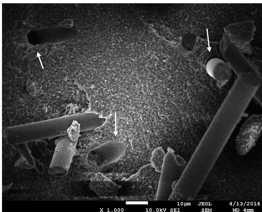
Obr. 19 SEM snímek lomové plochy zkušebního tělesa s nesilanizovanou výztuží a plnivem
