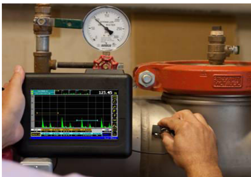
Obr. 28 Defektoskop od firmy Danatronics iFlaw v praxi[14]
