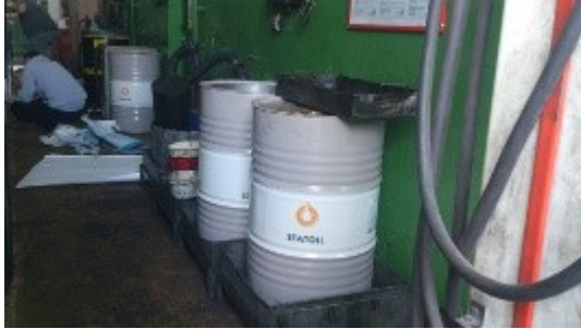
Foto č. 1: Záchytné vany pod sudy – opravár.dílňa
