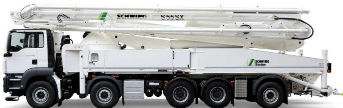
Obr. 42: Autočerpadlo betonu Schwing Stetter S 55 SX [23]
