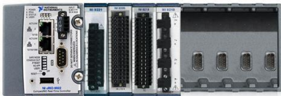
Obr. č. 26 - Merací systém cRIO s príslušnými meracími kartami
