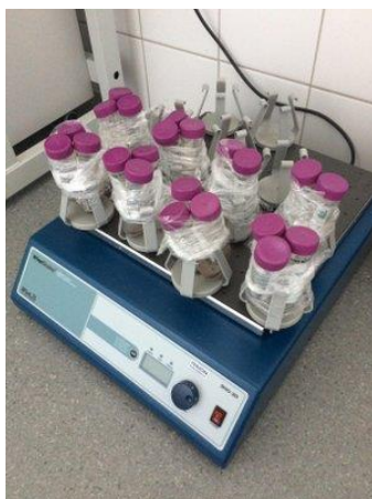
Obrázek 18 Umístění vzorků do třepačky SHO-2D, 230 V
