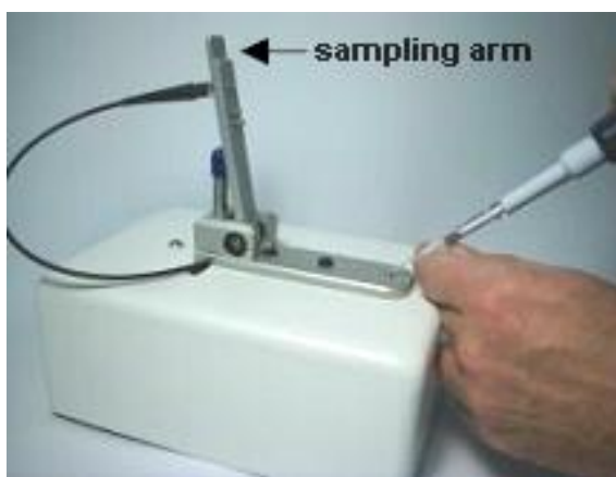
Obr.11: Horní a dolní rameno Nanodropu 1000 (manuál Nanodrop 1000)
