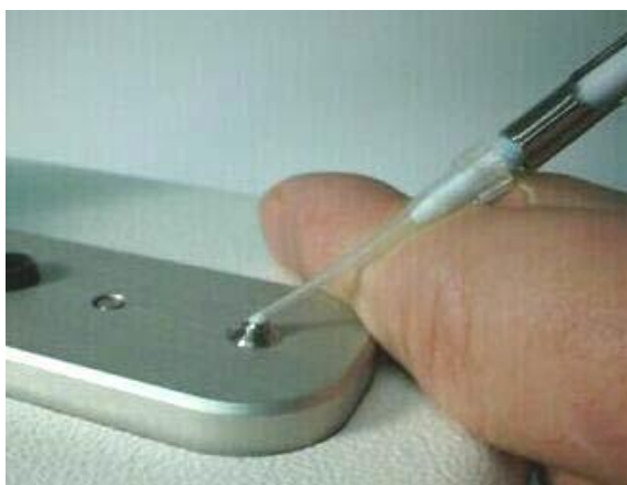
Obr. 12: Podstavec dolního ramena pro nanášení Blanku a vzorku (manuál Nanodrop 1000)
