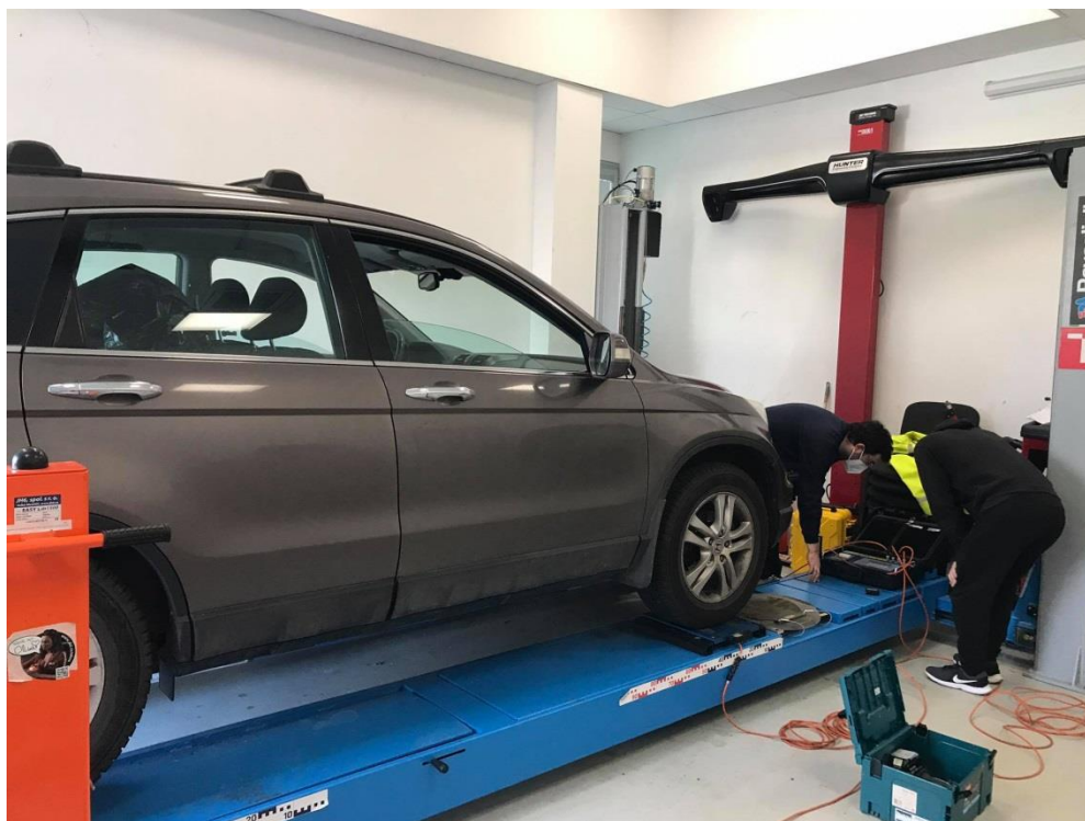
Obrázek 17 Ukázka měření – příprava vážení vozidla ve vodorovné poloze [vlastní]
