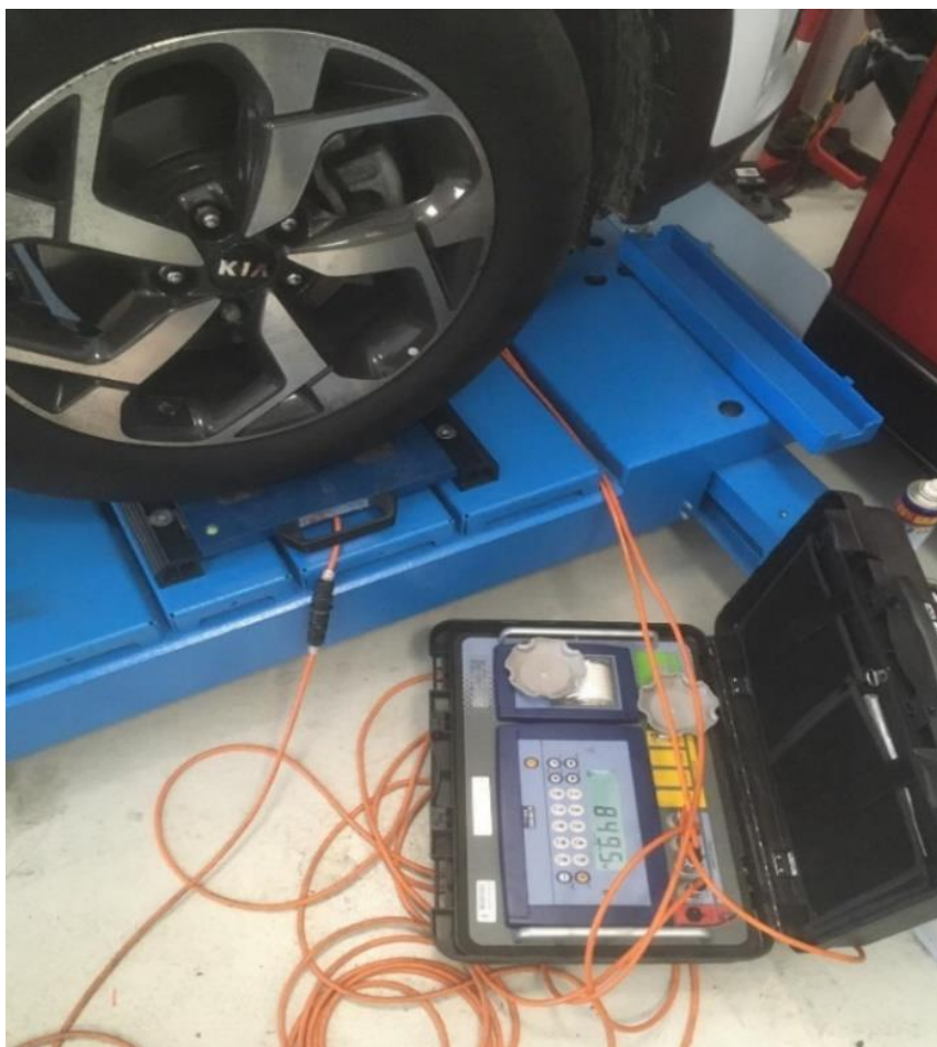
Obrázek 15 Nápravová váha značky Dino Argeo [vlastní]
