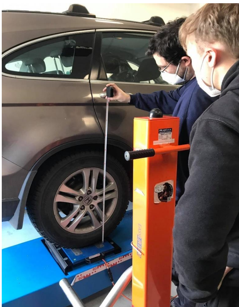
Obrázek 18 Zjišťování výšky orientačního bodu na karoserii vozidla [vlastní]
