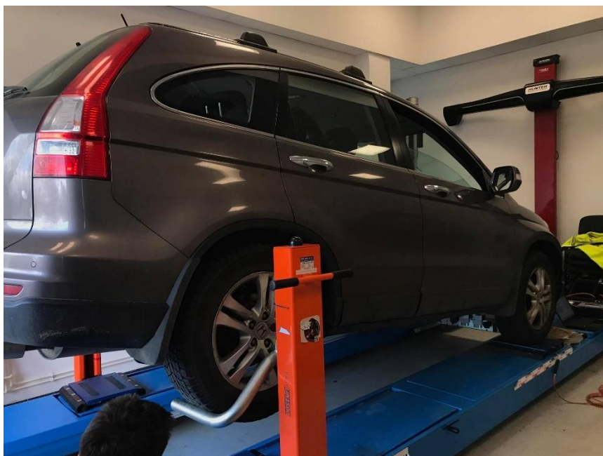
Obrázek 19 Měření hmotnosti vozidla naklápěného na přední nápravu [vlastní]
