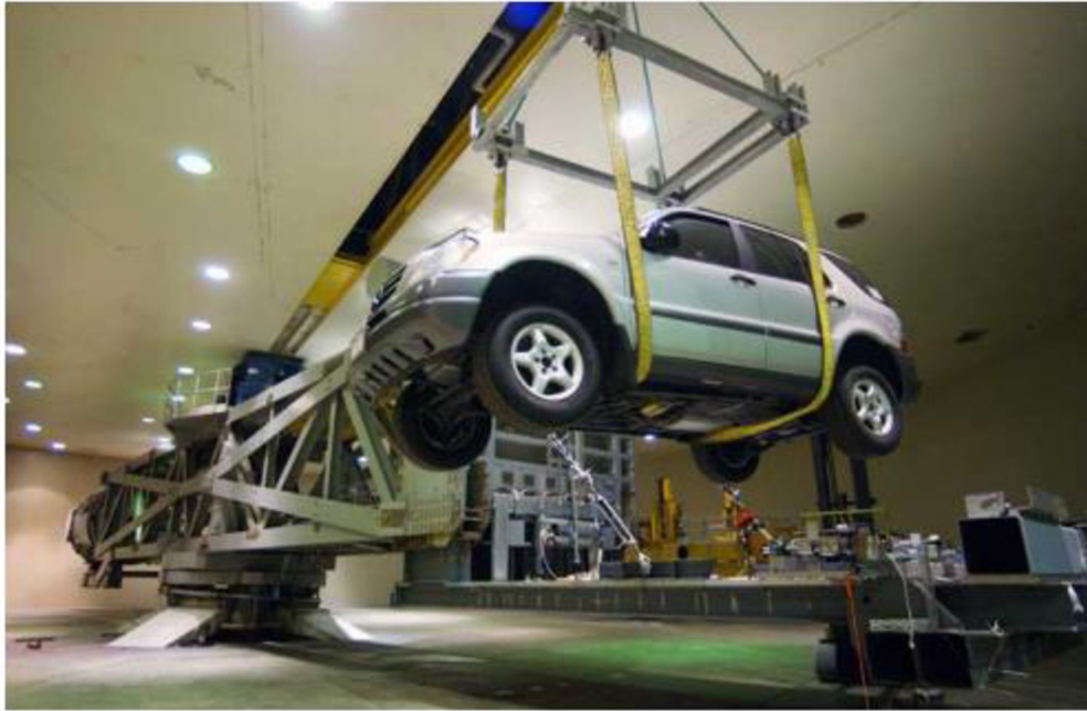
Obrázek 14 Umístění vozidla na platformu centrifugy pomocí jeřábu [13]
