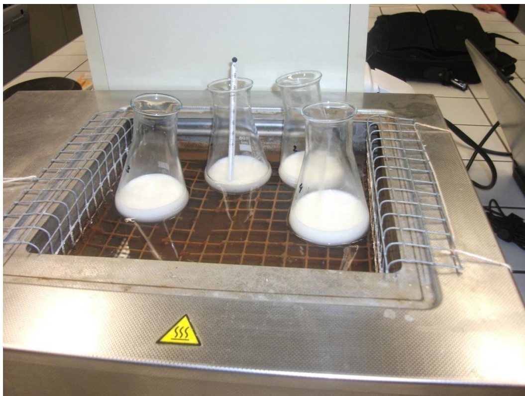
Foto č. 3 Ohřev vzorků mléka pro stanovení syřitelnosti, kvality sýřeniny a syrovátky
