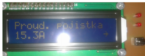
Obr. 4.10: Nastavení proudové pojistky
