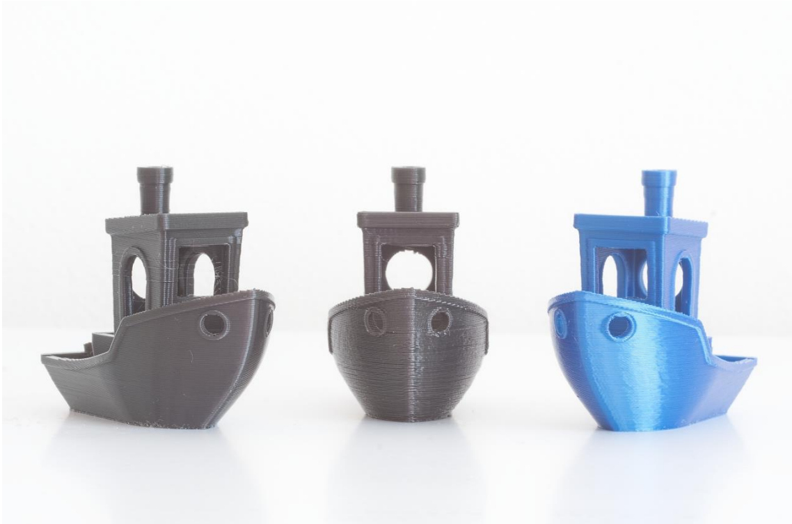
Obrázek 11 - Lodička Benchy: vlevo Prusa Mini +, uprostřed Anet A8, vpravo Trilab Deltiq 2. Autor: [autor]
