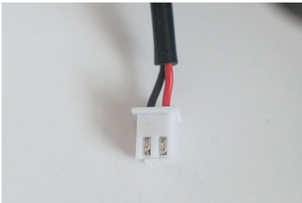
Obrázek 22. Správně orientovaný konektor laserového modulu. Autor: [autor]
