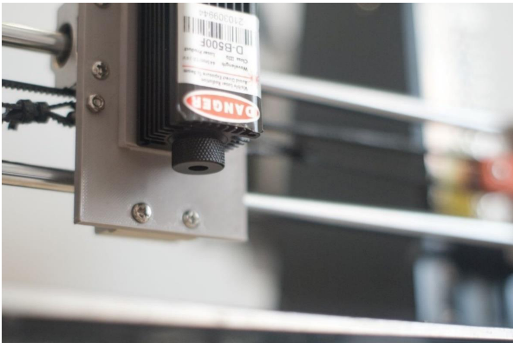
Obrázek 25. Detail na kolečko ostření optiky laseru. Autor: [autor]
