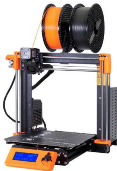
Obrázek 7 - FDM tiskárna Prusa i3 MK3S+ [21]
