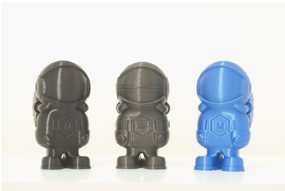
Obrázek 10 - Porovnání výtisků astronauta: vlevo Prusa mk3s+, uprostřed Anet A8, vpravo Trilab Deltiq 2. Autor: [autor]
