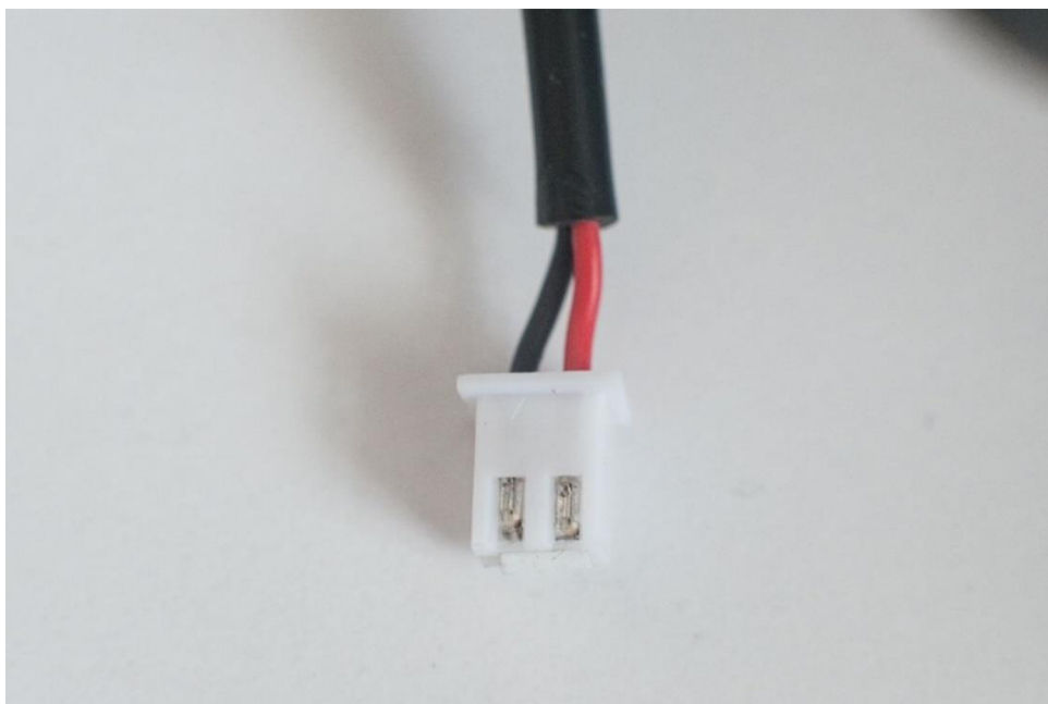
Obrázek 22. Správně orientovaný konektor laserového modulu. Autor: [autor]
