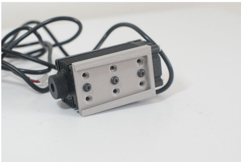
Obrázek 20. Připevněný díl k laserovému modulu. Autor: [autor]
