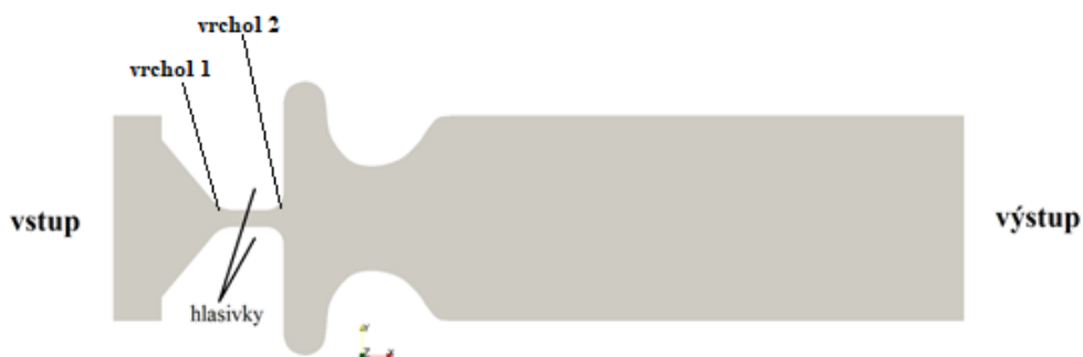
Obr. 47: 2D výpočetní oblast reprezentující zjednodušenou geometrii hlasivkového traktu.
