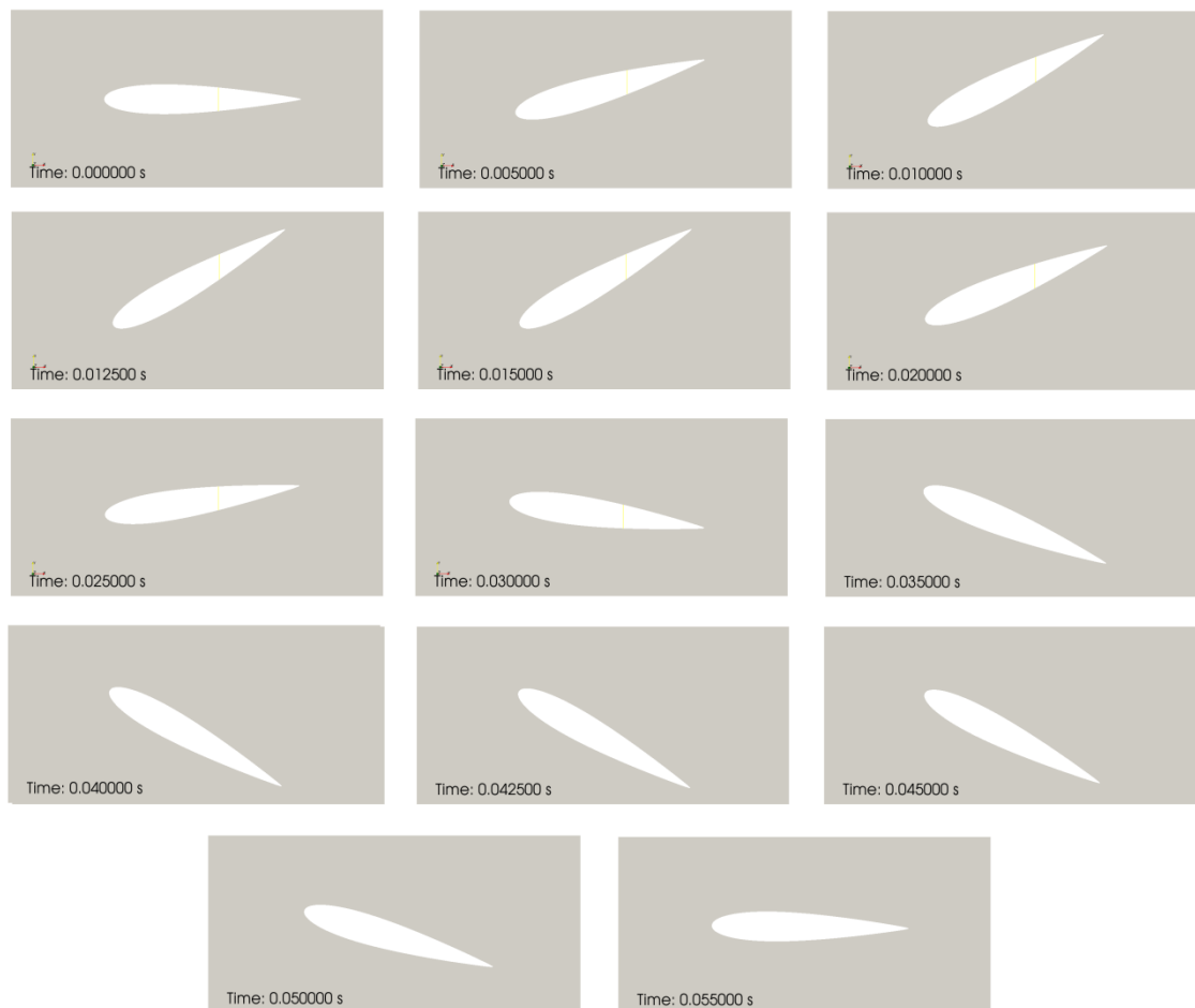
Obr. 18: Pohyb leteckého profilu v průběhu jedné periody (55 ms) s maximální výchylkou v rotaci 29,5^\circ a posuvem 2,1 mm.
