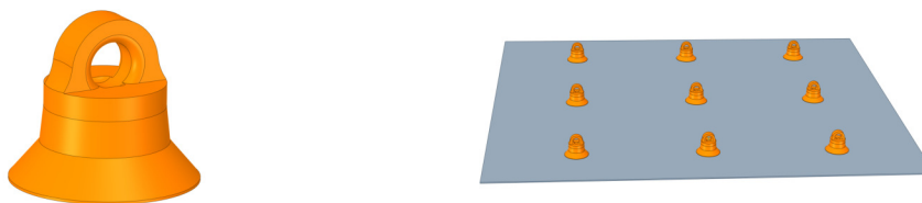
(a) Model geometrie vzorku, průměr podstavu 13.68 mm (b) Rozmístění vzorků na podložce pro tisk
