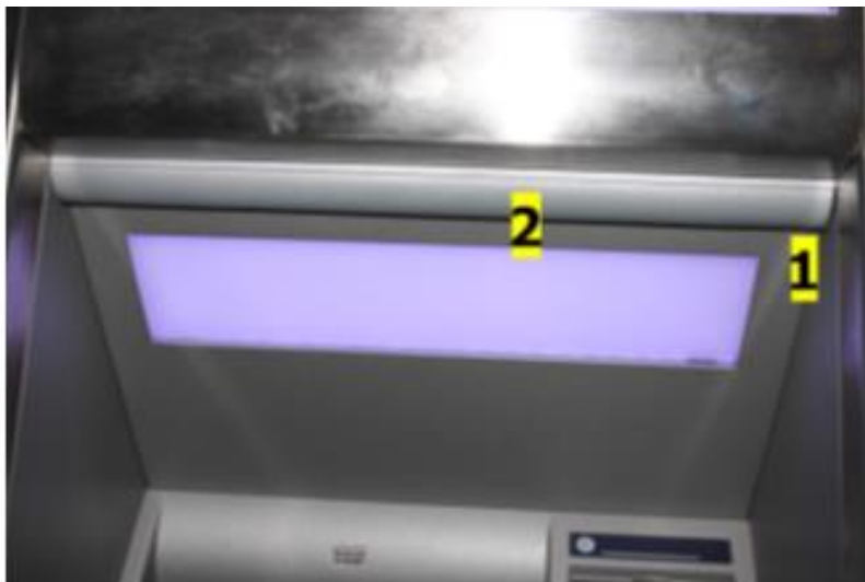
Obr. 3 Lišta, ve které je uložena mikrokamera a další elektronické součástky – její umístění je obvykle takové, aby mikrokamera mohla zachytit zadávání PIN kódů – v horní části bankomatu či v horní části nad obrazovkou, popřípadě v místě otvoru pro výdej hotovosti.
