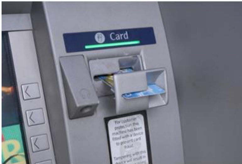
Obr. 2 Ukázka nasazení nelegální čtečky do antiskimmovacího nástavce.
