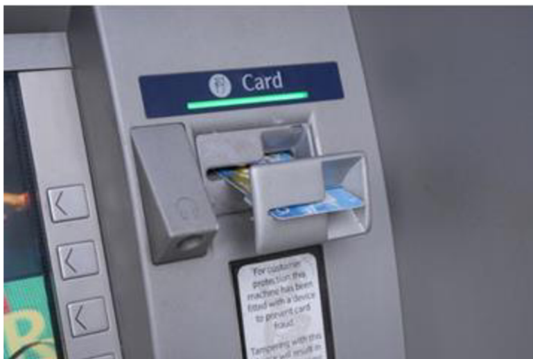
Obr. 2 Ukázka nasazení nelegální čtečky do antiskimovacího nástavce.
