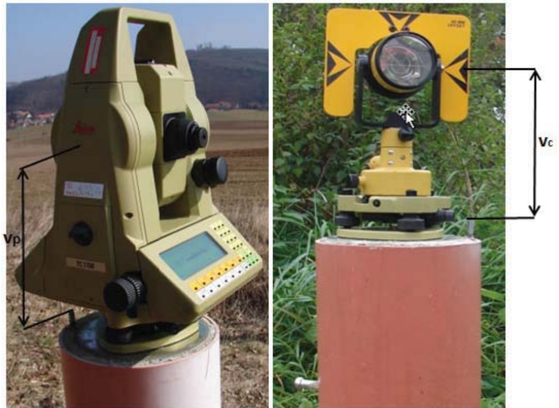
Obr. 7.2. Znárodnenie merania výšky prístroja Leica TC 1700 a odrazného hranolu Topcon od závitú stabilizovaného na pilieri
