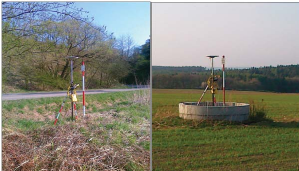
Obr. 10.3. Rýchla statická observácia vľavo na bode 000943022510 a vpravo na bode GEO (000943070023) siete Dopnul
