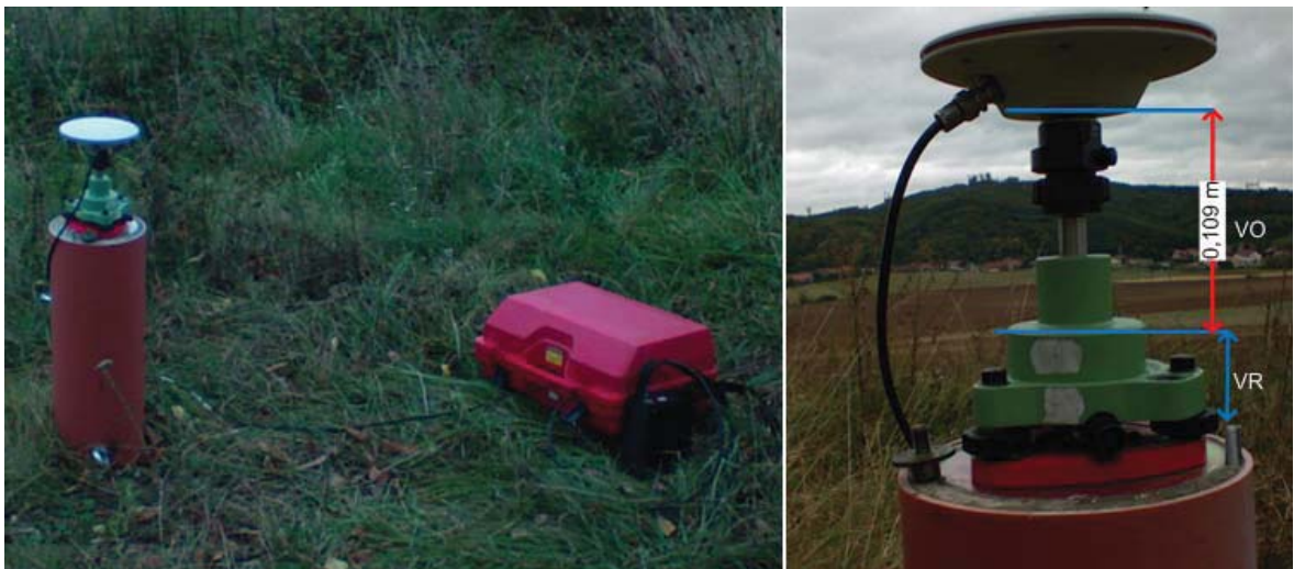
Obr. 8.2. Znáznornenie merania aparatúrou Leica SR520 osadenej na pilieri P4 a merania výšky antény na pilieri
