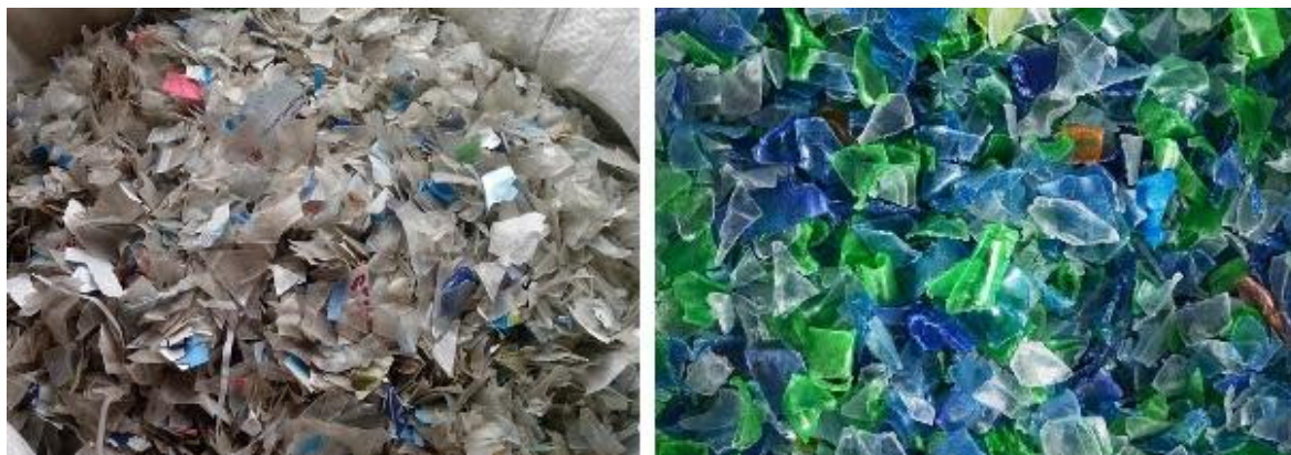
Obr. 5: PET flakes: vlevo- suchý proces [19], vpravo - mokrý proces [20]
