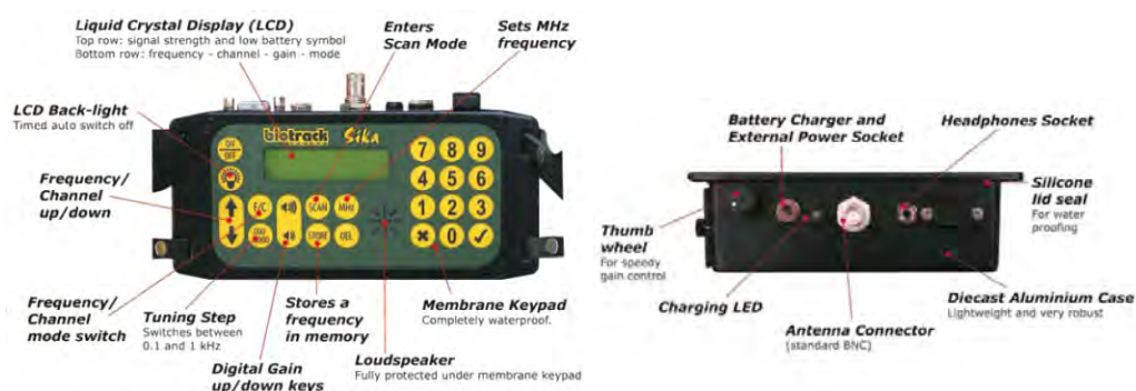
Obr. 1 Speciální přijímač „Sika“ firmy Biotrack, frekvenční rozsah 138 – 174 MHz, velikost 150 × 85 × 55 mm, hmotnost 800 g (foto: http://www.biotrack.co.uk/pdf/sika.pdf ).
