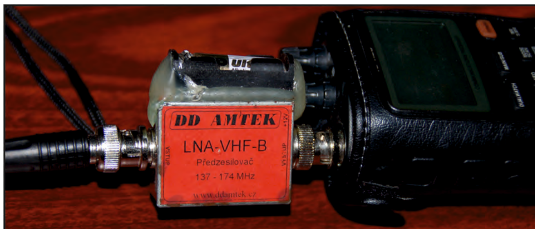
Obr. 10 Laděný nízkošumový předzesilovač LNA-VHF-B firmy DD AMTEK pro frekvenční pásmo 137-174MHz.
