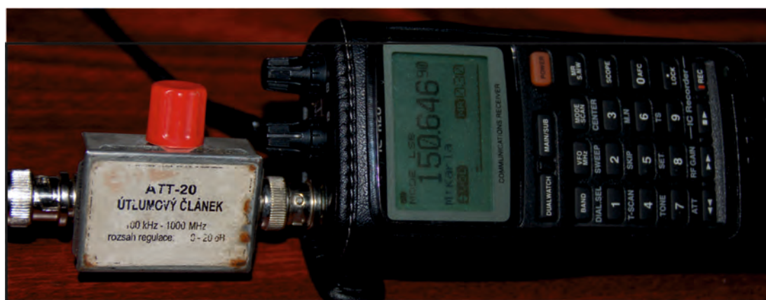
Obr. 9 Proměnný atenuátor ATT-20 firmy DD AMTEK; 0 – 20 dB; 0,1 – 1 000 MHz.
