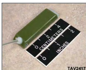
Obr. 12 Jeden z nejmenších vysílačů systému Argos (TAV-2417), váha 16,6 g, celková doba vysílání 527 hodin. (foto: http://www.telonics.com ).
