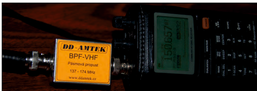
Obr. 8 Pasivní pásmová propust BPF-VHF firmy DD AMTEK pro 137 – 174 MHz. Útlum okolo 2 dB a kmitočty nad i pod propustným pásmem zeslabuje o více než 40 dB.
