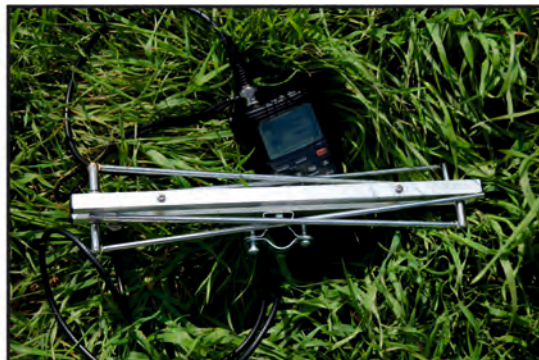
Příloha 1 Yagi antény: skládací dvouprvková, pevná tří a čtyřprvková, upevněná na teleskopickém stožáru na automobilu.
