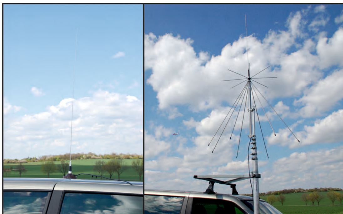
Obr. 7 Prutová anténa s magnetickým držákem a discové anténa na složeném teleskopickém stožáru umístěné na vozidle.
