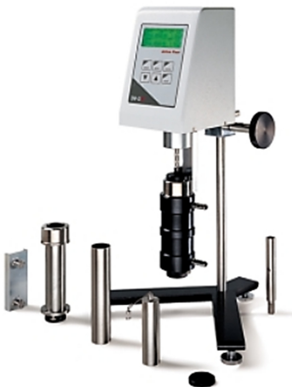
Obr. 12: Viskozimetr Anton Paar DV-3P (Rofa.at, 2017)
