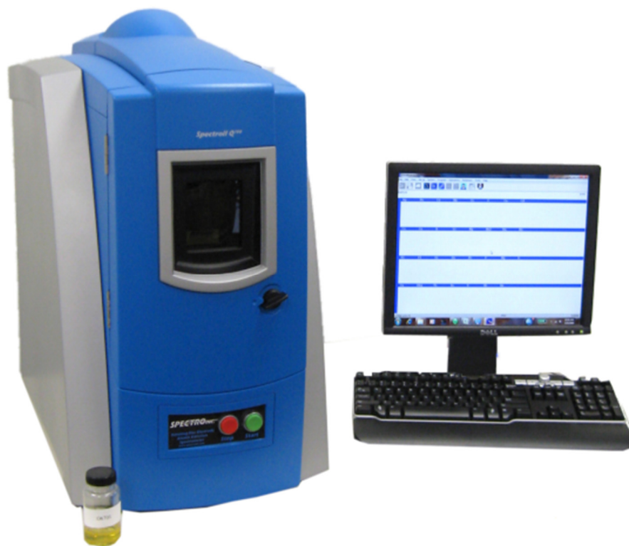
Obr. 13: Atomový emisní spektrometr Spectroil Q100 (Spectro.cz, 2017)
