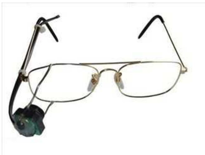
Obrázek 2. Zařízení pro ovládání počítače pohybem oka. Zařízení je připevněno na dioptrických brýlích. Zdroj: http://technet.idnes.cz/cesky-system-pro-ovladani-pocitace-ocima-jde-do-prodeje-pgx-/hardware.asp?c=A080902_143824_hardware_vse
