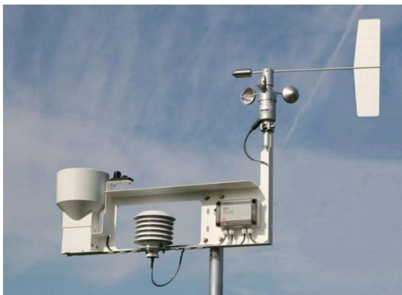
Obrázek 1.6 Profesionální automatizovaná meteorologická stanice, převzato z [1]
