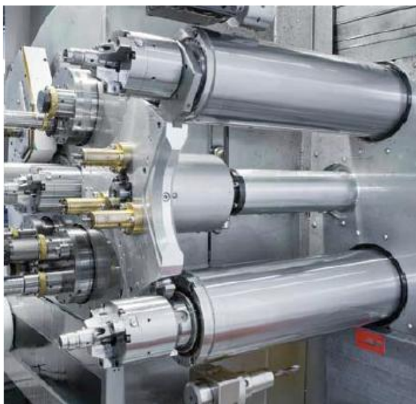
Obr 4.15 Protivřetena s manipulátorem [23].
