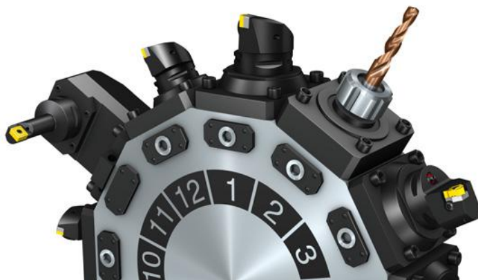
Obr. 3.12 Osazená revolverová hlava [12].
