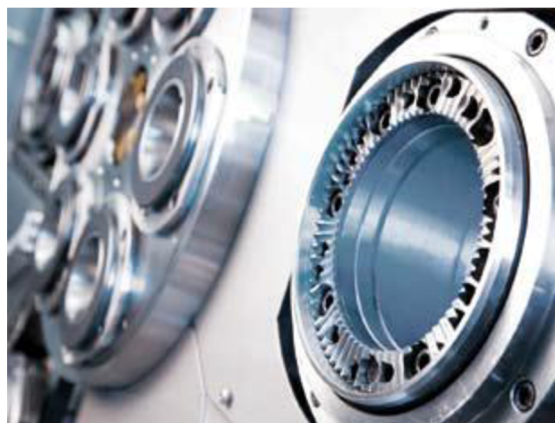
Obr. 4.8 Hirthovo ozubení pro revolverovou hlavici [23].
