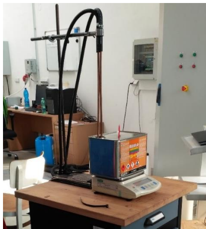
Obr. 25 Laboratorní váha VIBRA AJ-6200CE a její instalace při měření (vpravo) [62]
