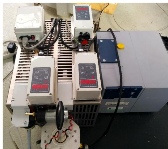
Obr. 23 Instalace MATRIX MG-5 při měření
