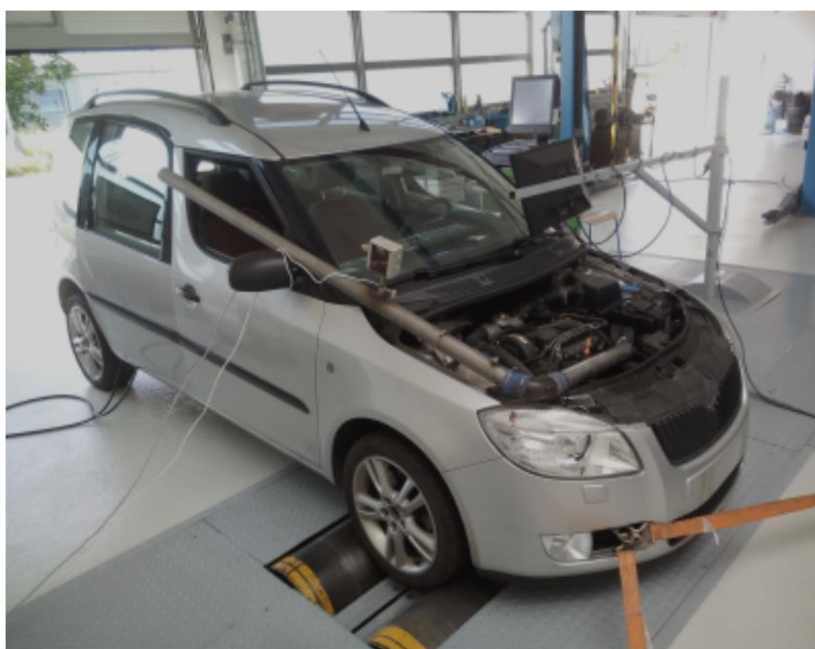
Obr. 30 Instalace vozu ŠKODA Roomster 1,4 TDI na válcové zkušebně ČZU
