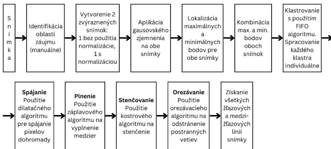
Obr. 2.5: Metodika detekcie meibomových žliaz použitá v práci od Koha a spol.[18]
