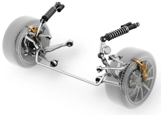
Obr. 3.2 Zavesenie Mercedes-Benz SLS AMG E-CELL [32]
