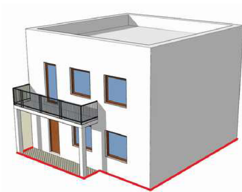
Obr. 9 - Zastavěná plocha stavby – předsašená sloupy podepřená konstrukce [10]
