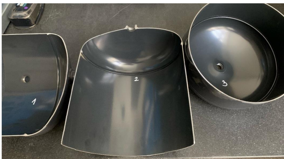
Obrázek 38 Číslování vzorků zevnitř vzduchojemu [vlastní]
