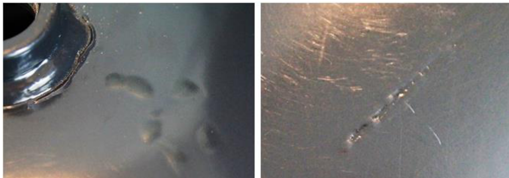
Obrázek 36 Vady laku – spadená barva (vlevo) a rýha (vpravo) [vlastní]
