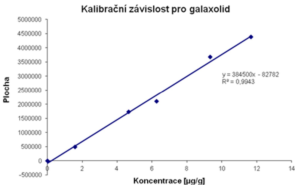
Obr. 18: Kalibra ní závislost koncentrace galaxolidu na plo–e píku
