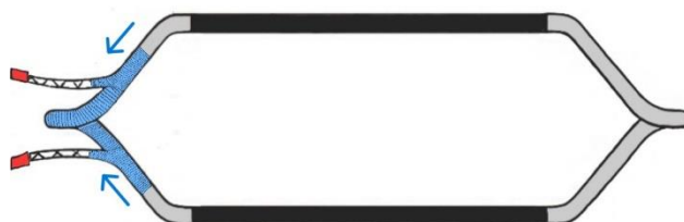
Obrázek č. 23: cívka - 2. ovíjení izolační páskou
