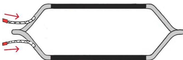
Obrázek č. 20: cívka – nasazení ochranného krytu
