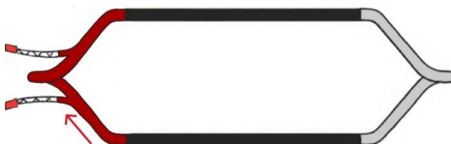
Obrázek č. 26: cívka - 1. ovíjení krycí páskou
