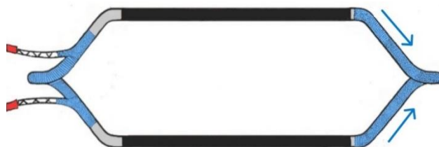
Obrázek č. 24: cívka - 3. ovíjení izolační páskou
