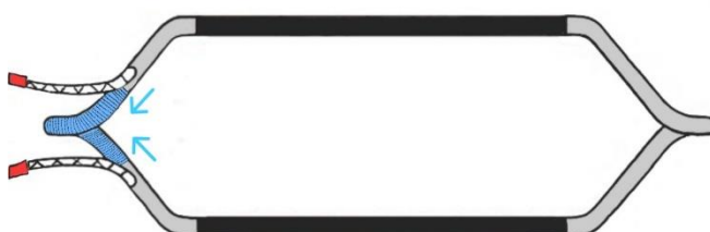
Obrázek č. 21: cívka - 1. ovíjení izolační páskou
