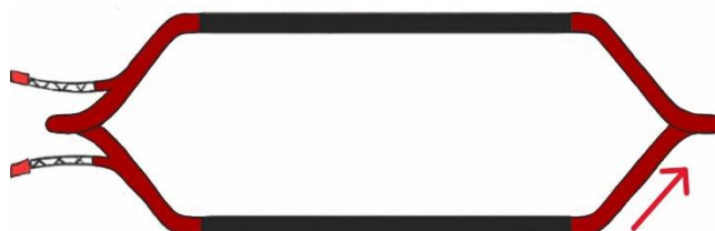
Obrázek č. 27: cívka - 2. ovíjení krycí páskou
