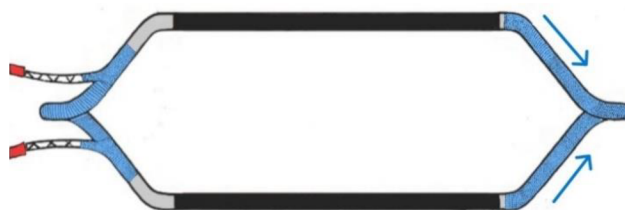
Obrázek č. 24: cívka - 3. ovíjení izolační páskou
