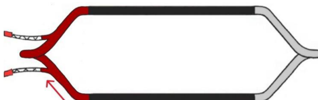
Obrázek č. 26: cívka - 1. ovíjení krycí páskou
