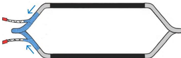
Obrázek č. 23: cívka - 2. ovíjení izolační páskou
