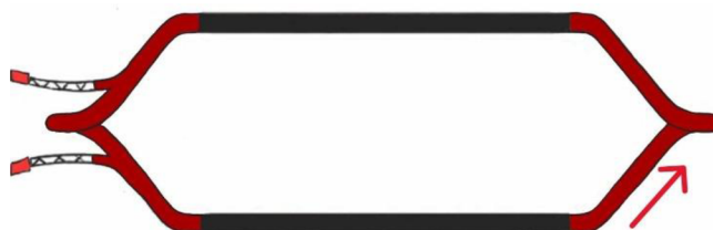
Obrázek č. 27: cívka - 2. ovíjení krycí páskou
