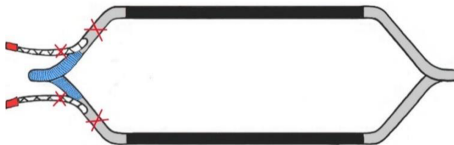
Obrázek č. 22: cívka – zakreslení 1.orientačních bodů
