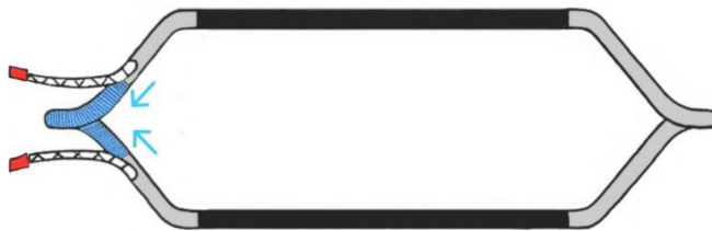
Obrázek č. 21: cívka - 1. ovíjení izolační páskou
