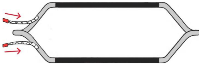
Obrázek č. 20: cívka – nasazení ochranného krytu
