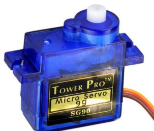
Obrázek 5.10: Servo, které je využito pro uchopovací mechanismus. 3
