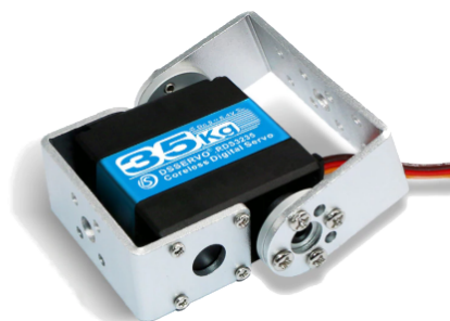
Obrázek 5.9: Servo, které je využito pro klouby a otočnou bázi. 2
