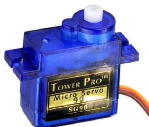
Obrázek 5.10: Servo, které je využito pro uchopovací mechanismus. 3
