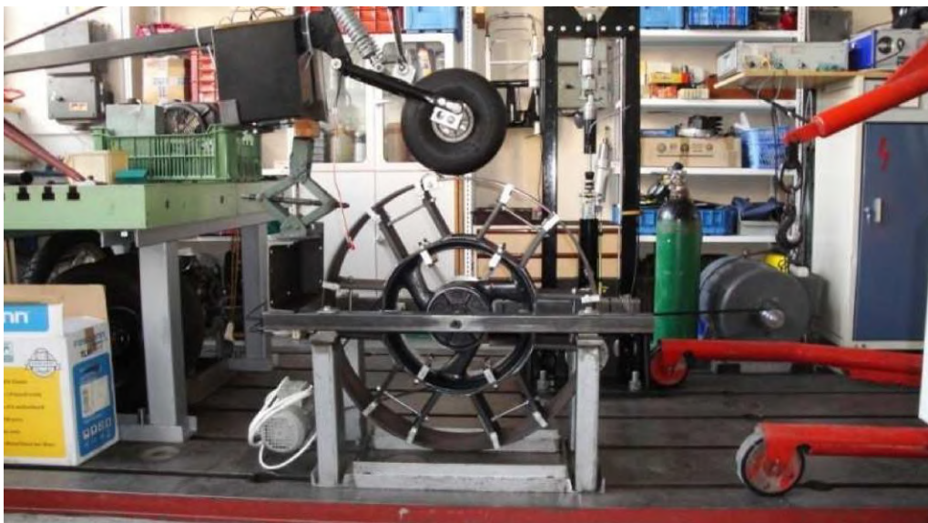
Obr. 1 Nezakrytovaný vozík a tester Dynotec [2]
