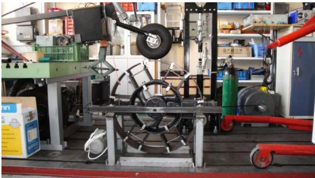
Obr. 1 Nezakrytovaný vozík a tester Dynotec [2]
