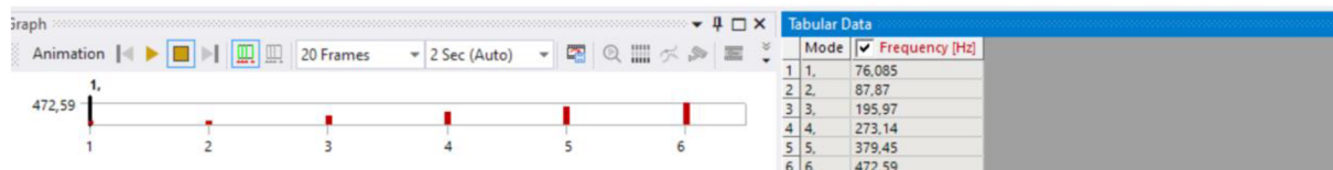
Obr. 37 Vlastní frekvence zatíženého ramene s překážkou na konci dráhy (volný konec)
